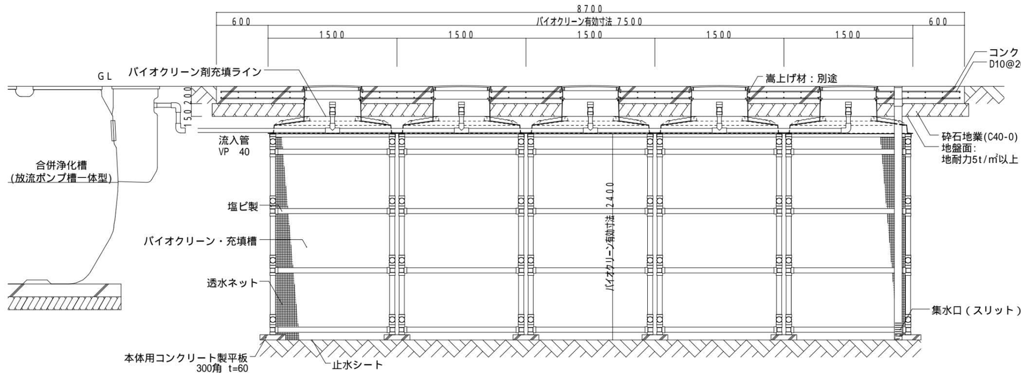
掘削寸法図(高上げ無しの場合)
