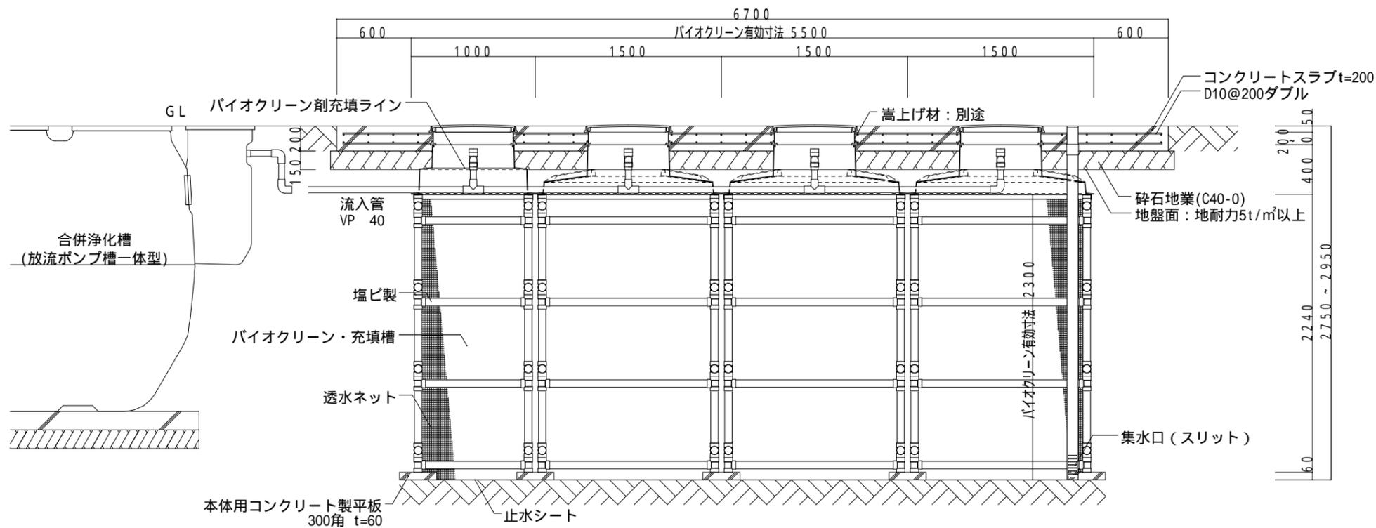
掘削寸法図(高上げ無しの場合)
